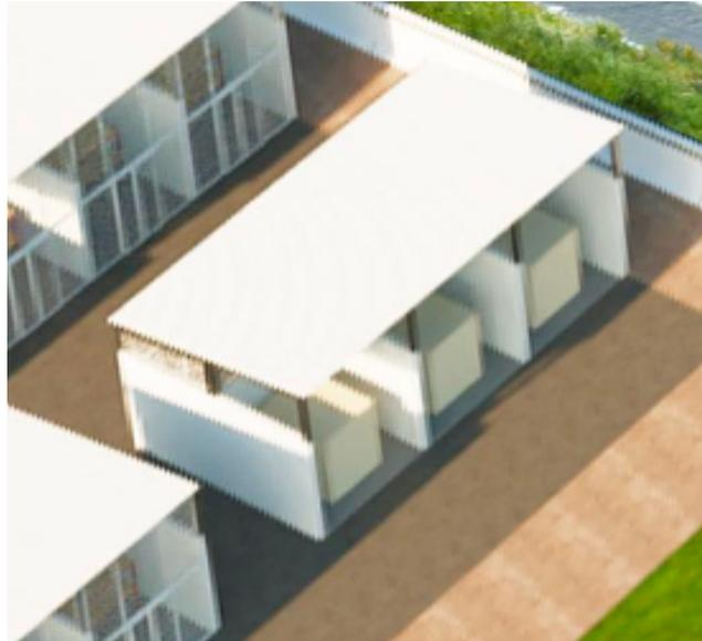
Figure 11 : Composition des alvéoles de stockage pourvu de containers
