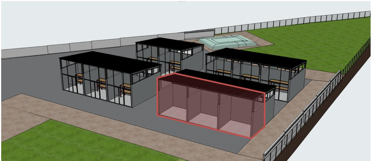
Parmi ces **3 alvéoles** munis de cette solution de stockage en container avec détecteur incendie, **2 alvéoles seront dédiées aux « batteries neuves »** et **1 alvéole sera dédiée à des « batteries en quarantaine »**.
