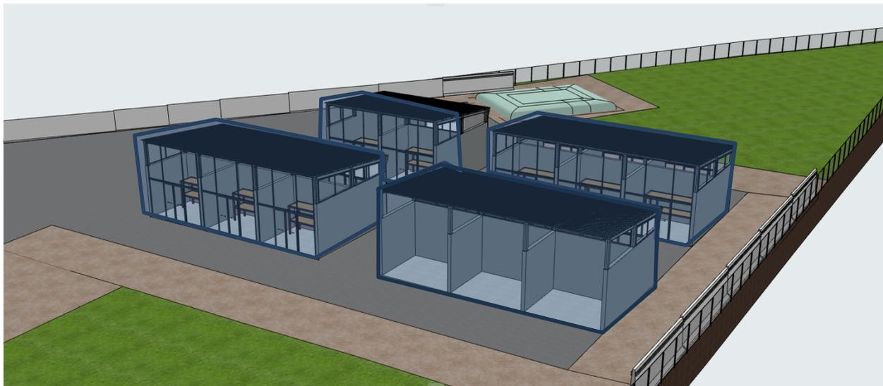
Alvéoles de stockage des batteries en rack munis d'un système de détection et d'extinction automatisé : 17
