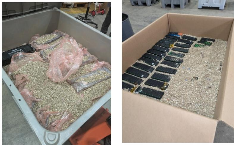
Figure 8 : Exemples de conditionnement bacs + vermiculite
