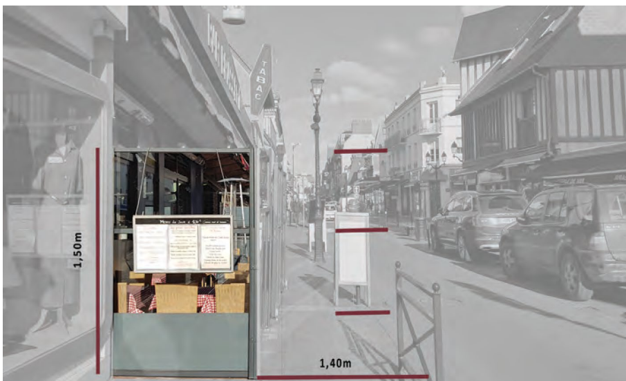
Un soubassement plein d'une hauteur comprise entre 55 et 80 cm
