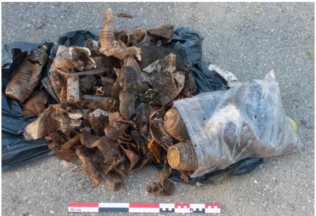
Fig. 29. Vue de la masse de débris issus du curage du receveur
