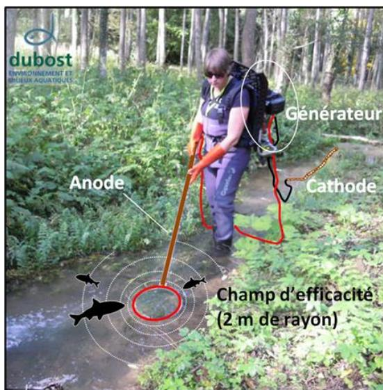
Figure 3 : Principe de la pêche électrique
