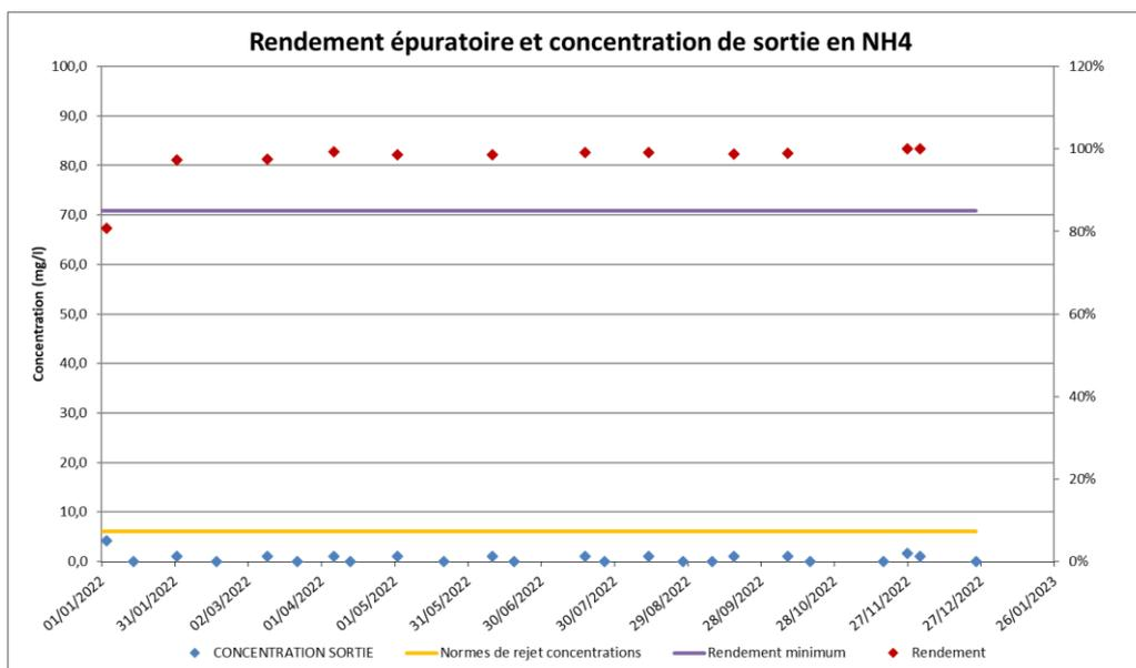
Figure 4-6 : Rendements et concentrations de NH4 enregistrées en sortie de station
