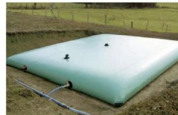
Figure 47 : Exemple de réserves d'eau artificielles souple
