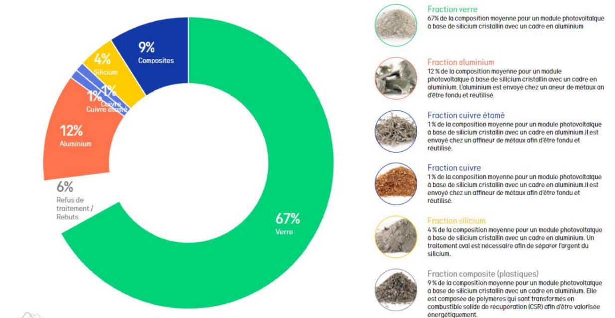
Figure 27 : Différentes fractions composant un panneau photovoltaïque (Source : Soren)
