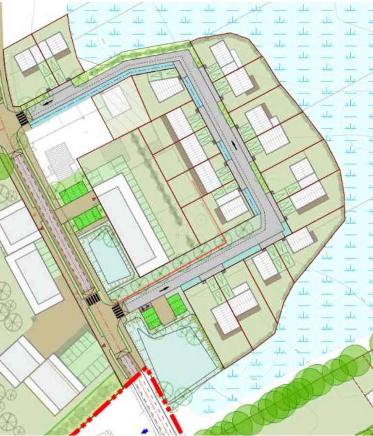
Figure 28 : Plan du secteur Jaunais Sud 1, décomposition des surfaces et Coefficients d'infiltration retenus
