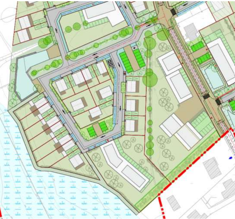
Figure 29 : Plan du secteur Jaunais Sud 2, décomposition des surfaces et Coefficients d'infiltration retenus
