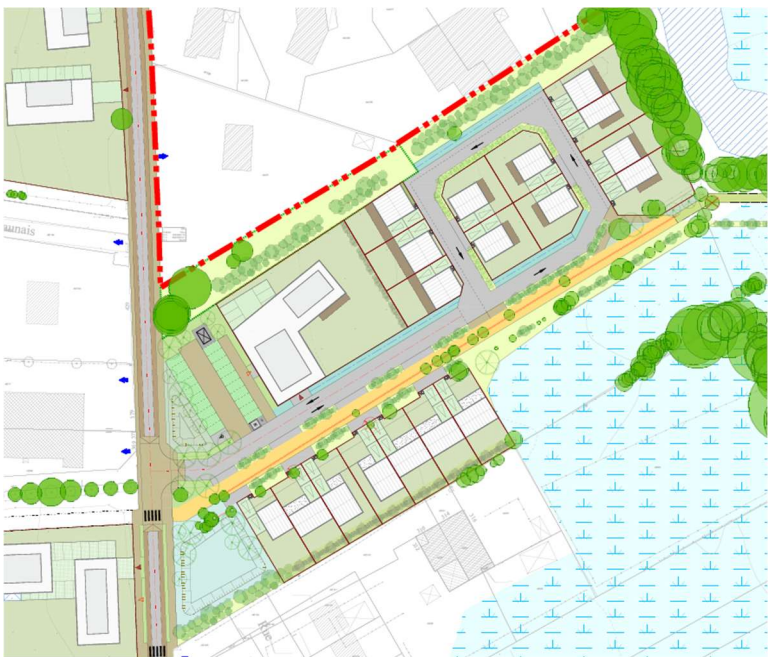
Figure 27 : Plan du secteur Jaunais Nord, décomposition des surfaces et Coefficients d'infiltration retenus
