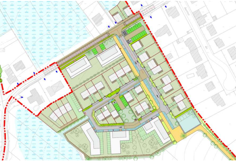
Figure 32 : Plan du secteur Ruisseau, décomposition des surfaces et Coefficients d'infiltration retenus
