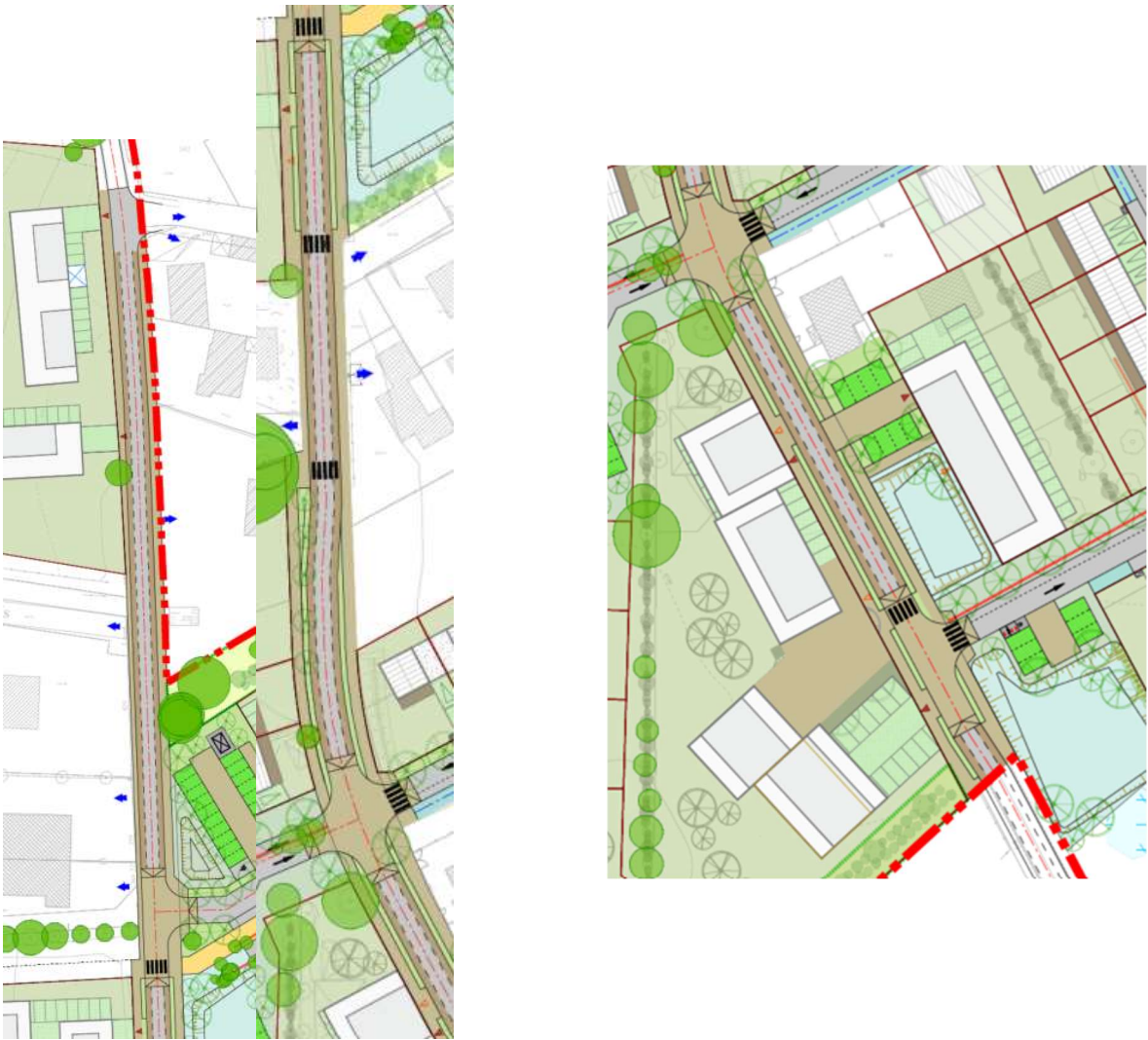
Figure 31 : Plan du secteur rue de Jaunais, décomposition des surfaces et Coefficients d'infiltration retenus
