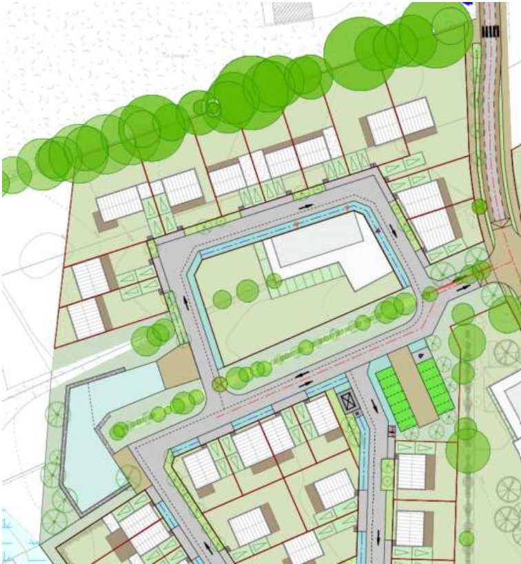
Figure 30 : Plan du secteur Jaunais Sud 3, décomposition des surfaces et Coefficients d'infiltration retenus
