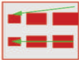
Dans l'architecture ancienne ou traditionnelle, les ouvertures sont disposées selon des axes verticaux, et leur taille va en décroissant vers le haut. Il est donc difficile de les modifier sans dommage.
