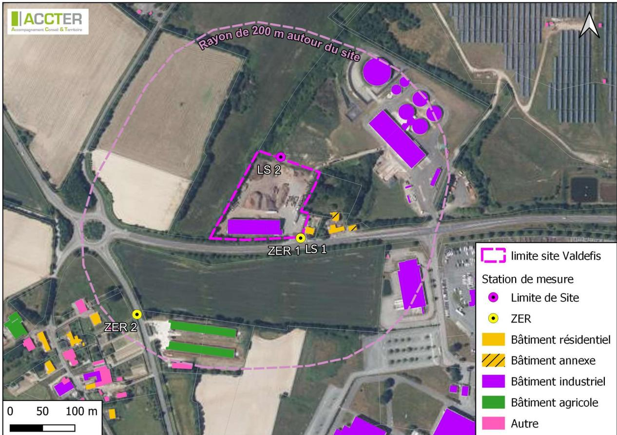
Figure 2 : Localisation des stations de mesure de bruit
