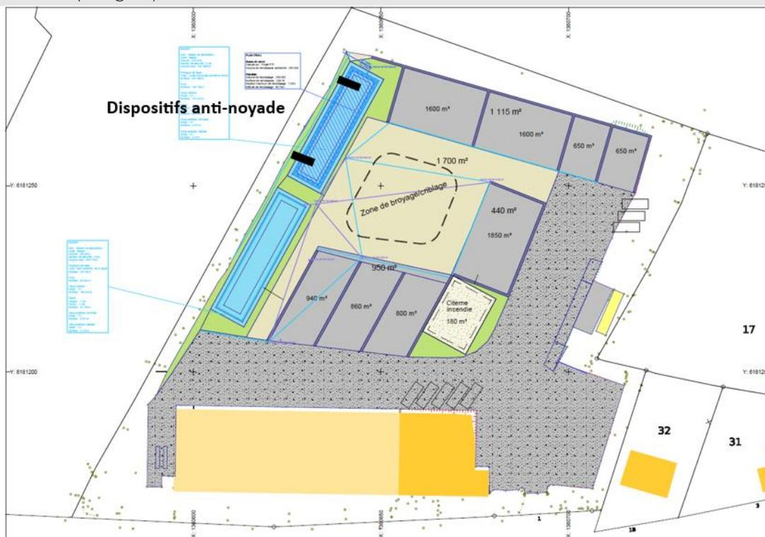
Figure 35 : Localisation du bassin nord et positionnement des dispositifs anti-noyade
