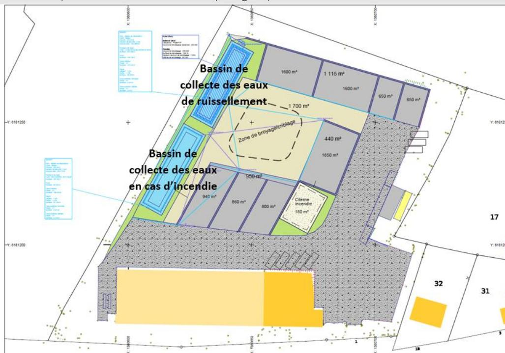
Figure 29 : Plan de gestion des eaux de ruissellement
