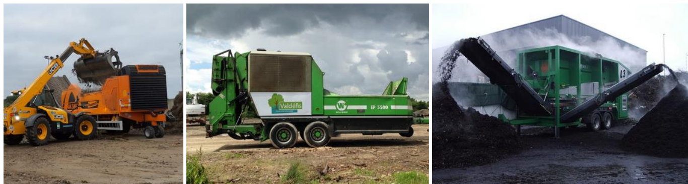
Illustration 23 : Broyeurs rapides DOPPSTAT AK560 et WILLIBALD SHARK II et crible (source : VALDEFIS)
