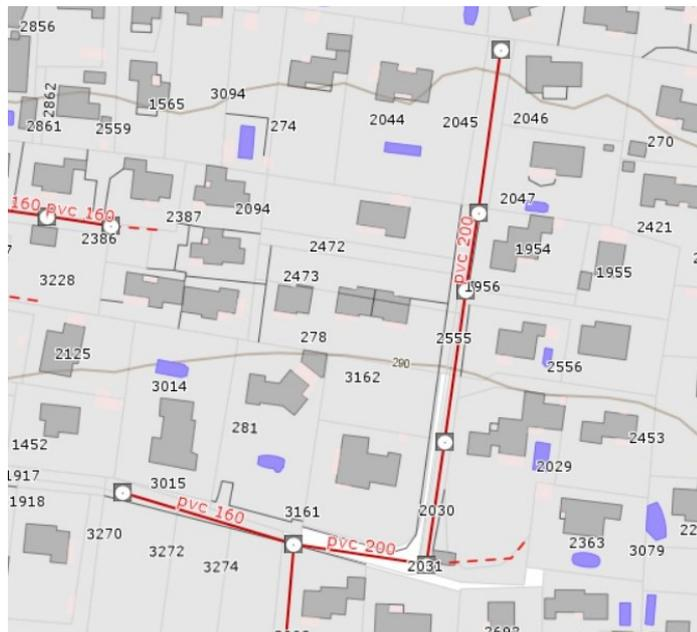
Figure 7 : Plan du réseau d'assainissement (source : Intragéo DLVA)
