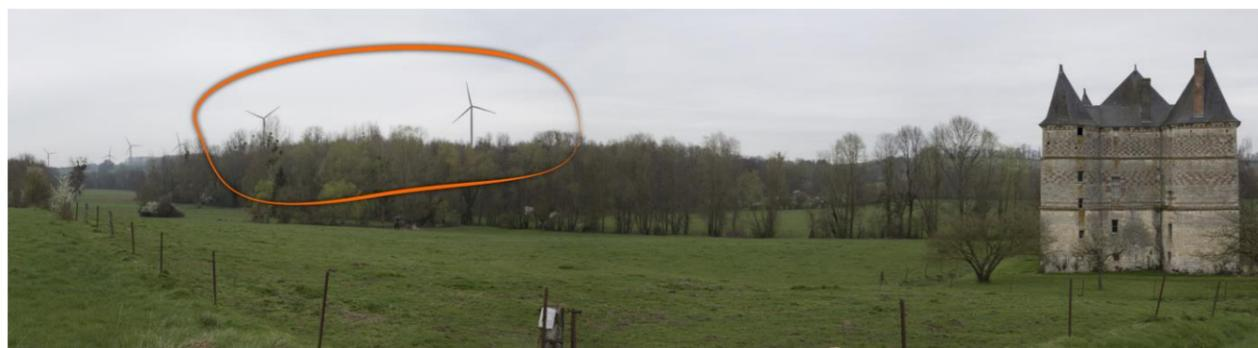
Photomontage n°11 – Variante 2 – Les éoliennes E5 et E6 mesurent 180 m en bout de pale (hauteur totale)
