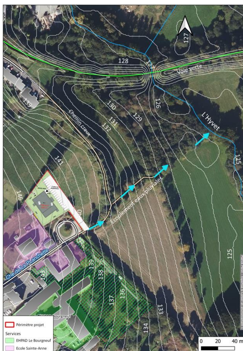
Carte 2 : principe d'évacuation des eaux pluviales
