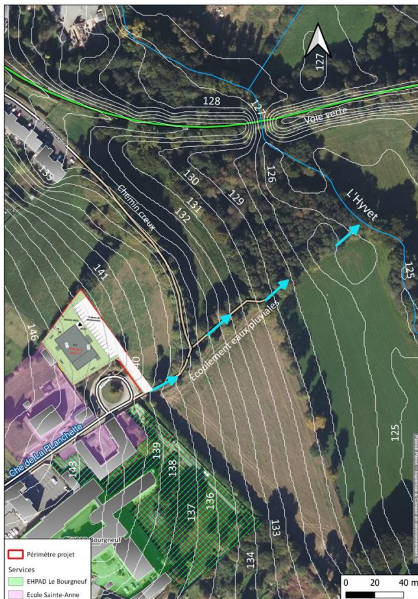
Carte 17 : principe d'évacuation des eaux pluviales
