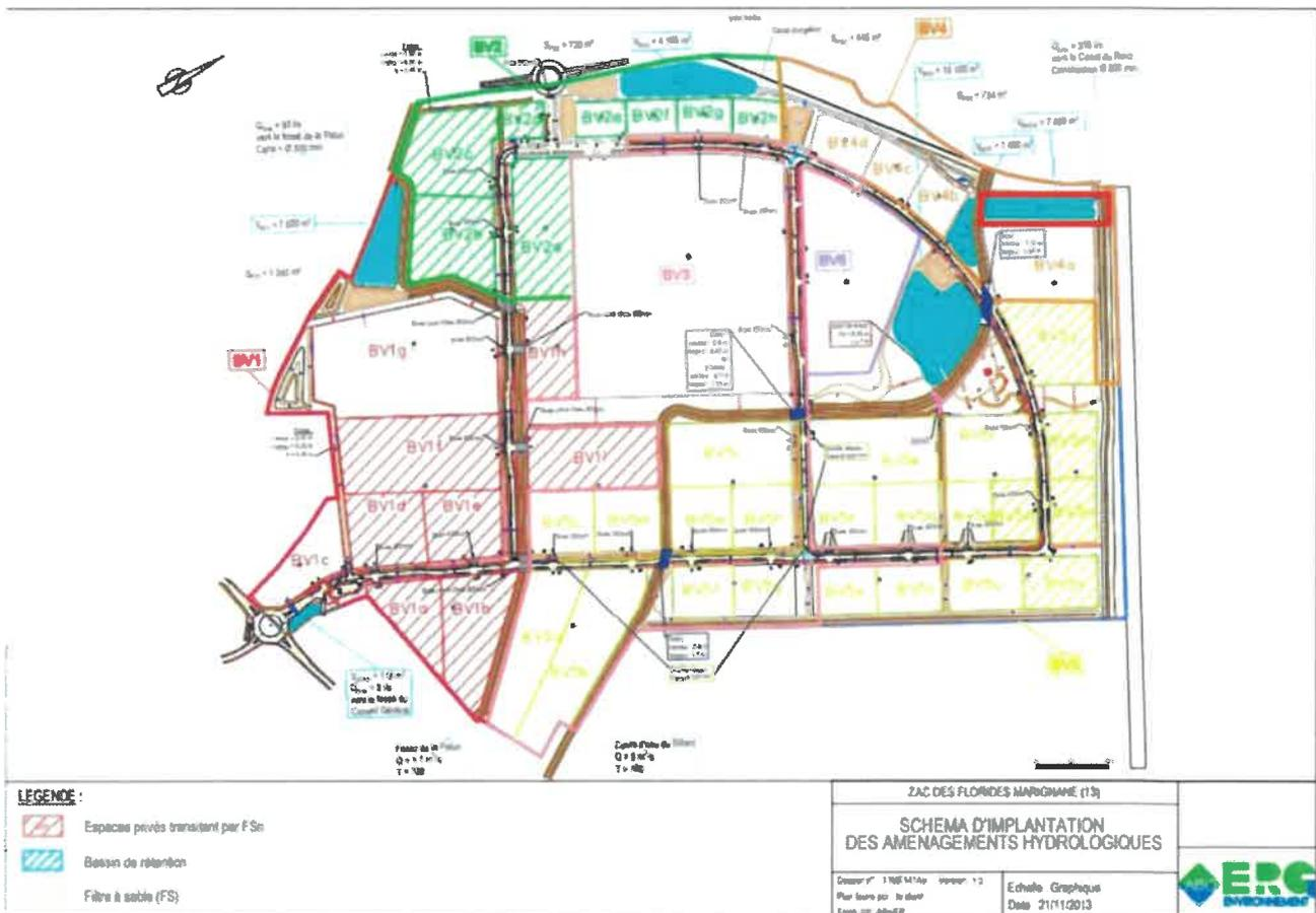
Ce bassin a lui-même un point de rejet sur le Canal du Rove avec un débit de fuite de 315 l/s via une conduite DN800.
