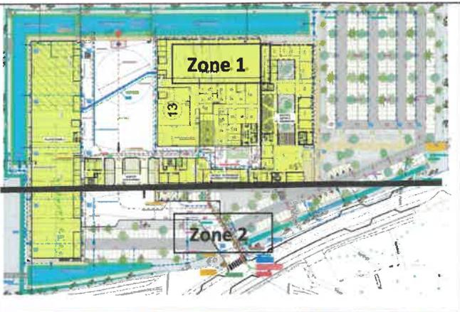
**Zone 1** avec une surface imperméabilisée de 1,66 ha.
