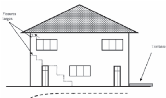
Figure 3 Mode de déformation provoqué par un retrait périphérique du sol sous la maison
