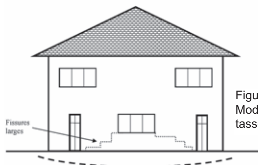
Figure 3 Mode de déformation provoqué par un retrait périphérique du sol sous la maison
