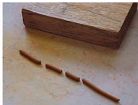
Essai de détermination de w_p ( w = w_p au moment de la photographie)
