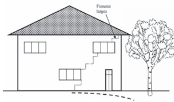
Figure 4 Mode de déformation provoqué par un retrait localisé du sol induit par la présence d'un arbre
