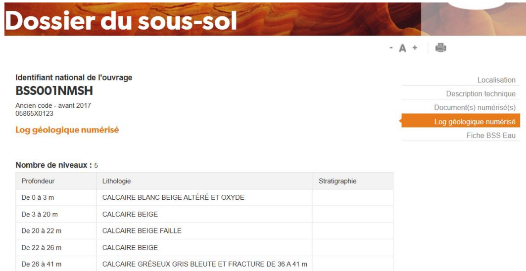
Figure 7 : Log géologique validé du forage BSS001NMSH (source : Infoterre)
