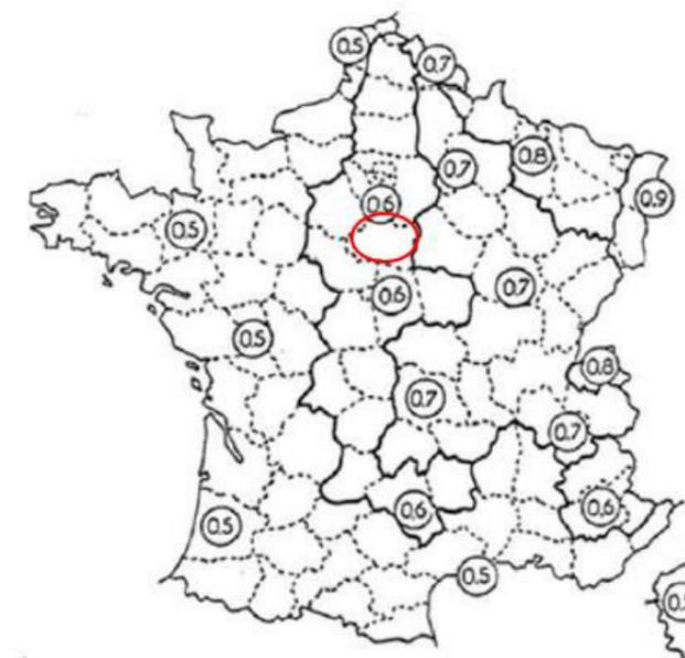
Figure 13: Carte de profondeur de mise hors gel (figure O.4.4.2 de la norme NF P 94 - 261)
