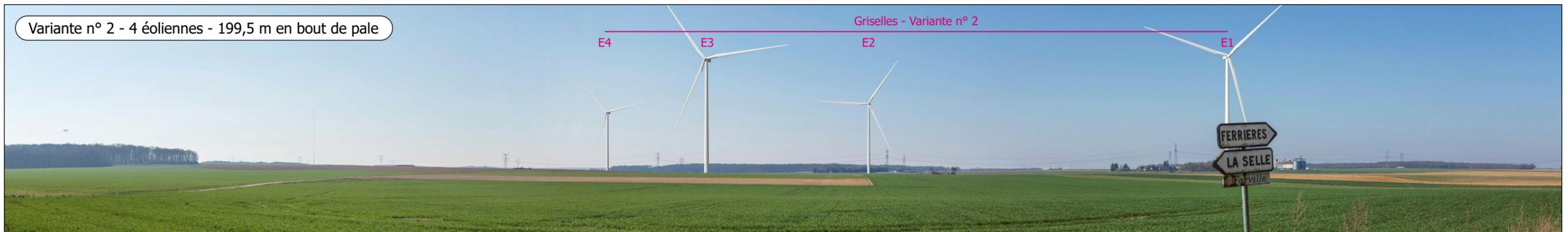
La variante n° 2 possède un angle horizontal plus restreint que la première variante. Les deux lignes la composant sont perçues ici en décalage, avec l'impression d'un front dense, mais sans refermer totalement l'espace. Les éoliennes E1 et E2 se superposent aux fermes de la Grande et de la Petite Ronce, avec des effets de surplomb. Cette variante engage une modification notable des rapports d'échelle existants du paysage.
