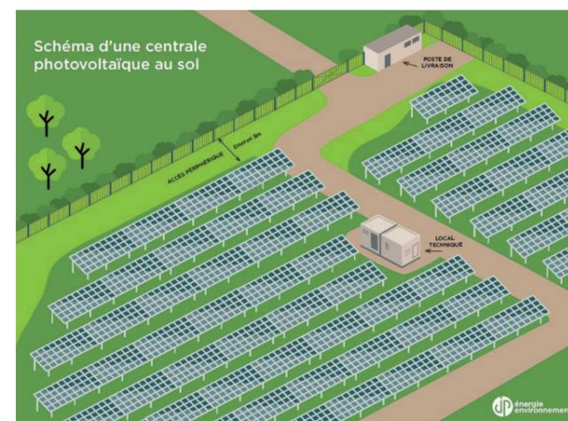
Figure 1 : Schéma de principe d'une centrale photovoltaïque au sol (source : JPee)
