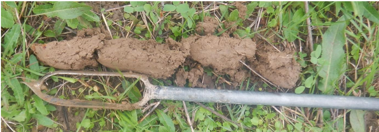
Photo 7 : Exemple de carottage réalisé sur une profondeur de 50 cm avant refus tarière (sondage 3)
