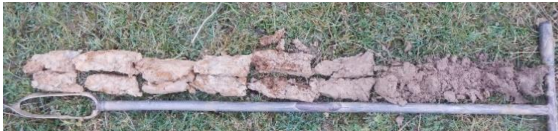
Photo 2 : Exemple de carottage sur une profondeur de 120 cm (Source : AEPE-Gingko)
