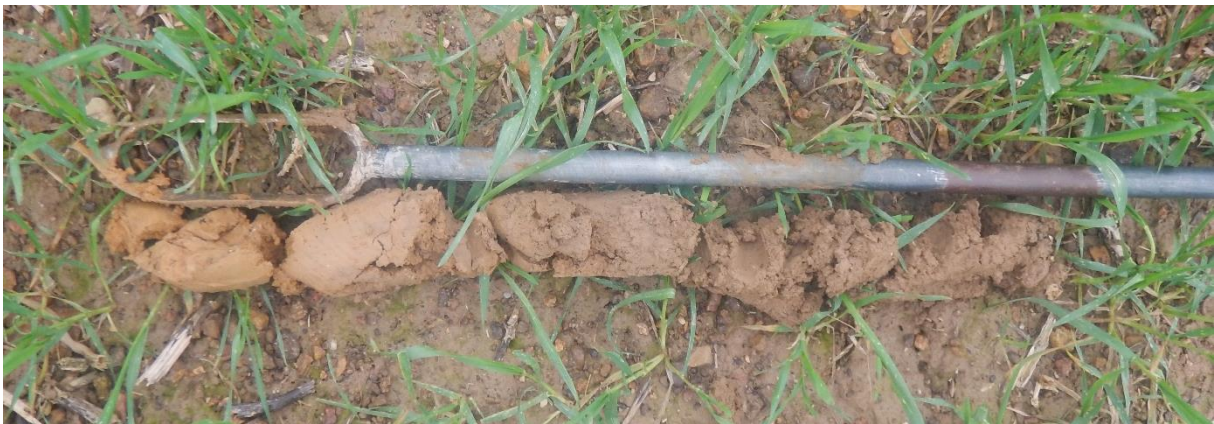
Photo 8 : Exemple de carottage réalisé sur une profondeur de 80 cm (sondage 11)
