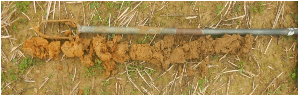
Photo 9 : Exemple de carottage réalisé sur une profondeur de 100 cm (sondage 17)
