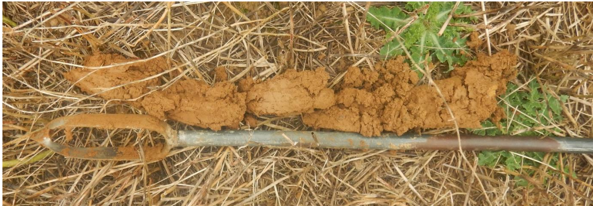
Photo 11 : Exemple de carottage réalisé sur une profondeur de 70 cm (sondage 37)
