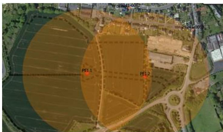
La défense contre l'incendie sera assurée par l'implantation de 2 hydrants (PEI) sur le domaine public et raccordés sur la nouvelle conduite de 160mm.
