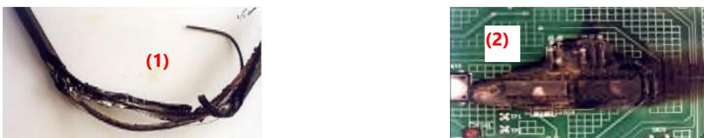
Figure 2 – Effet sur conducteur électrique (1) effets sur une carte électronique (2)
