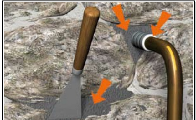
Situation après travaux de colmatage
