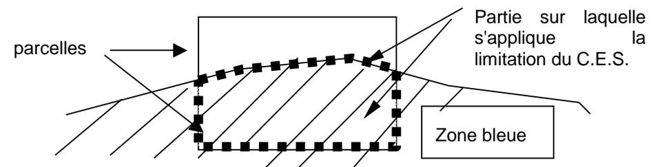
En cas de terrassements **en déblais**, la hauteur doit être mesurée par rapport au terrain naturel initial.
