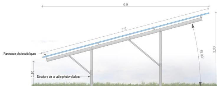
Schéma de principe d'une structure
