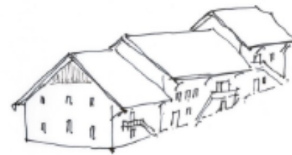
Les maisons mitoyennes étagées dans la pente (source : CRAUPE CCPEVA)
