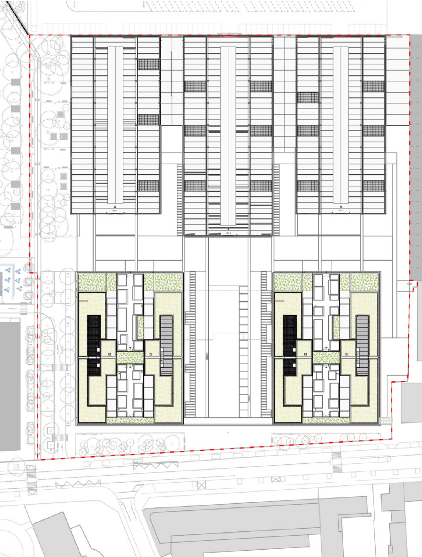
Des toitures plantées en R+1 et R+2 formant des corniches végétales - 40cm de terre
