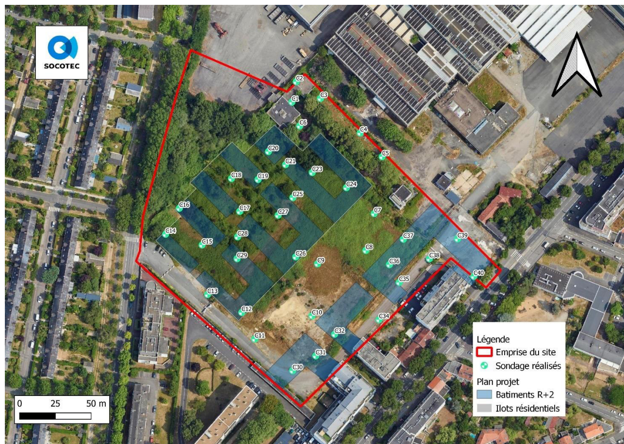
FIGURE 9 : SONDAGES DE SOLS REALISES
