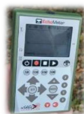
Figure 19 : Détecteur-Enregistreur d'ultrasons Echometer 3 (EM3)
