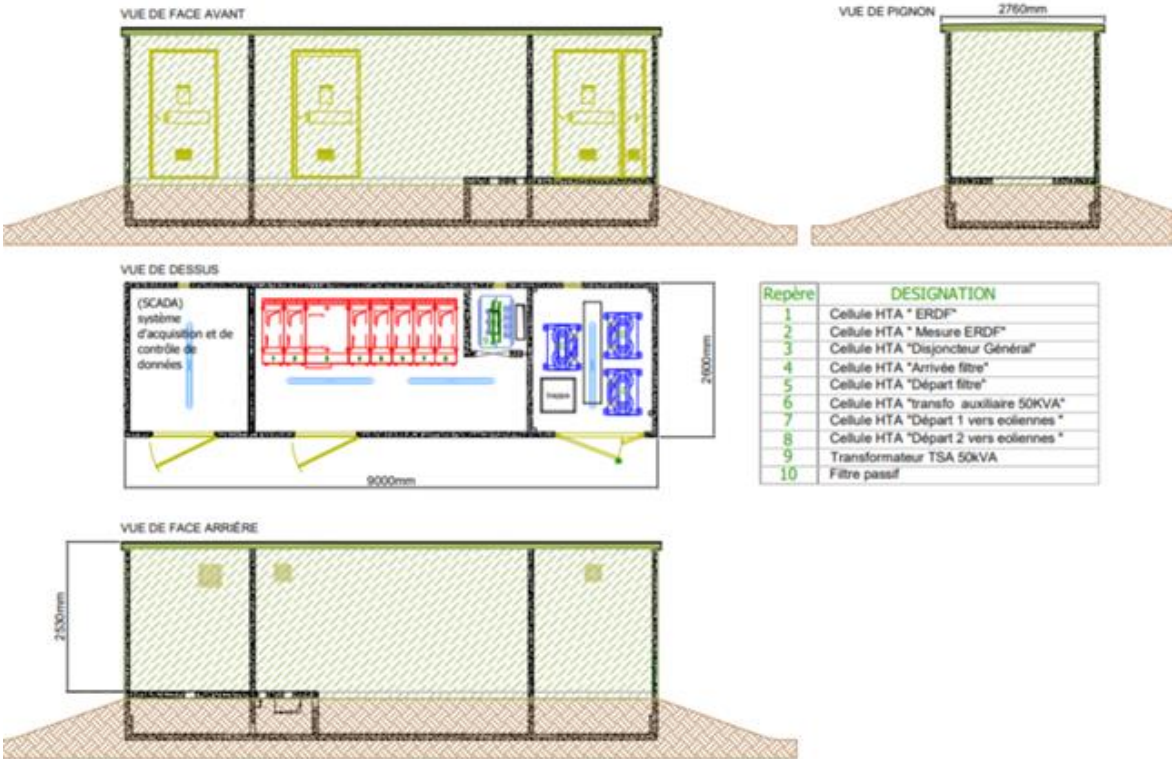
Figure 166 : Coupe-type du poste de livraison (Source : SAB)
