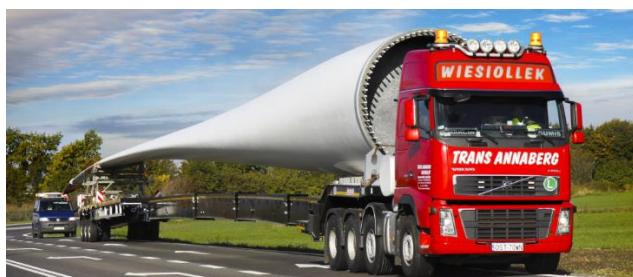
Figure 26 : Véhicule évolutif employé pour le transport de pale
