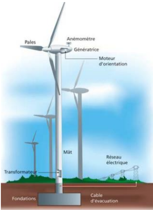
Figure 9 : Représentation schématique d'une éolienne (Source : EDF)
