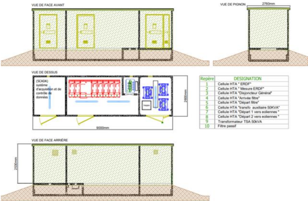
Figure 33 : Coupe-type du poste de livraison (Source : SAB)
