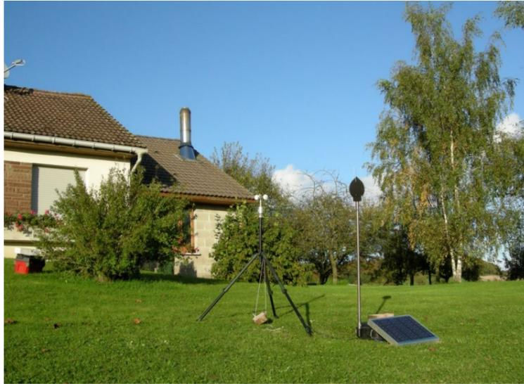
Figure 11 : Photographie d'un sonomètre en cours d'utilisation
