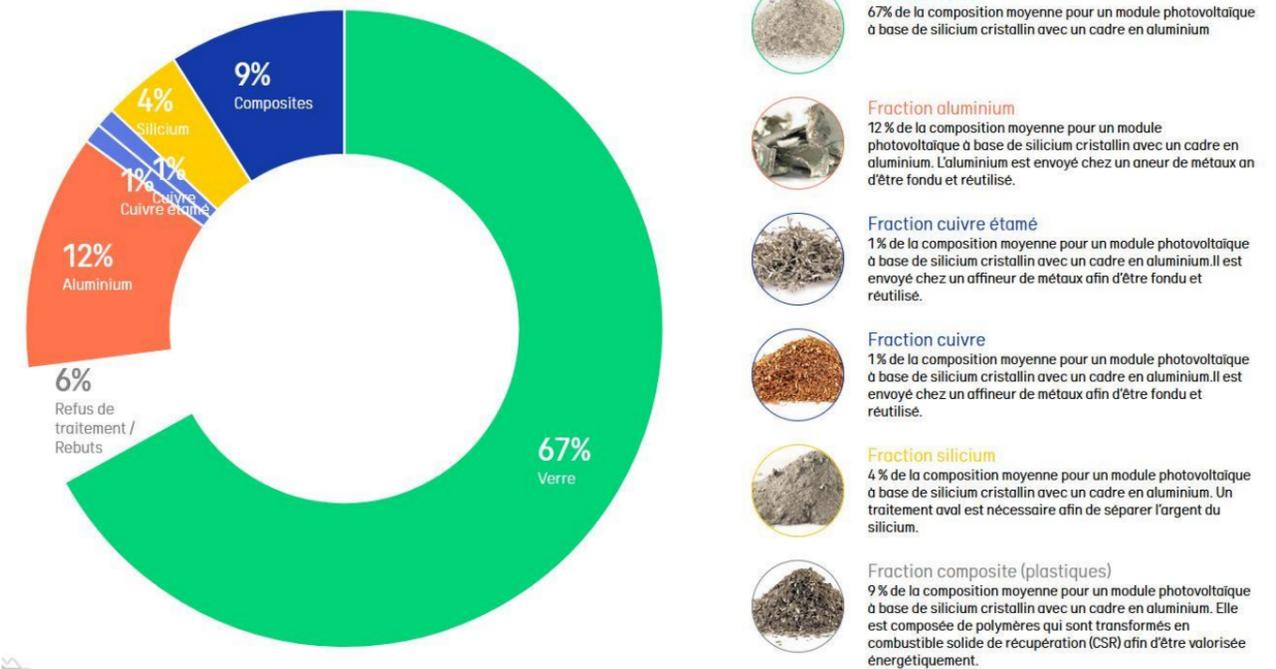
Figure 6 : Répartition des différentes fractions composant un panneau solaire photovoltaïque (Source : Soren)
