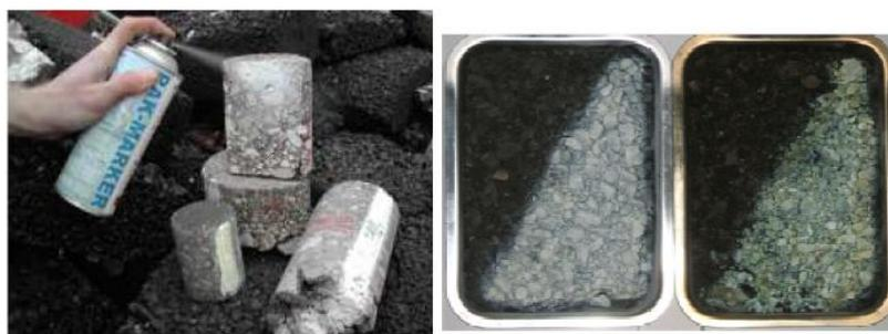
**Figure 5 : Procédure de détection des goudrons au PAK-MARKER (test négatif – test positif)**
