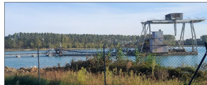
Drague et bandes transporteuses à Valff (ENCEN)
