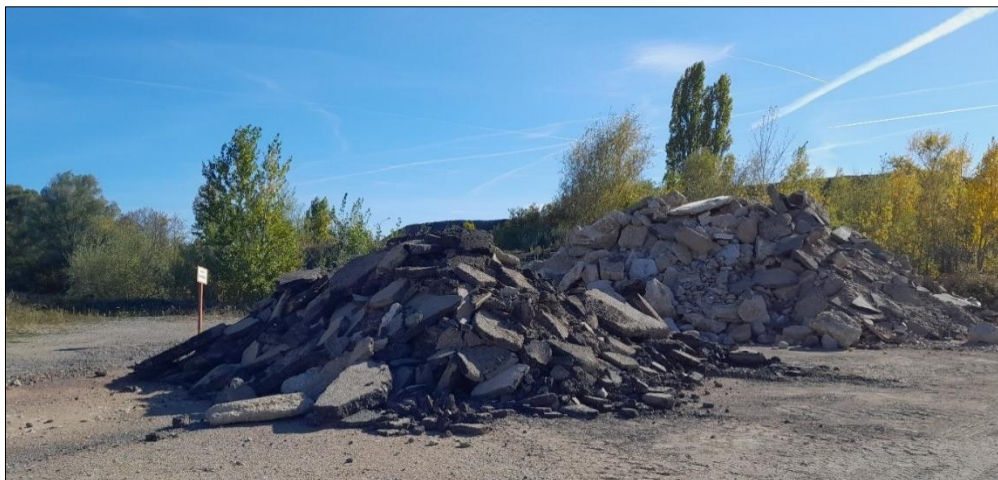
Figure 28 : Stockage de crouûtes d'enrobé (ENCEM)
