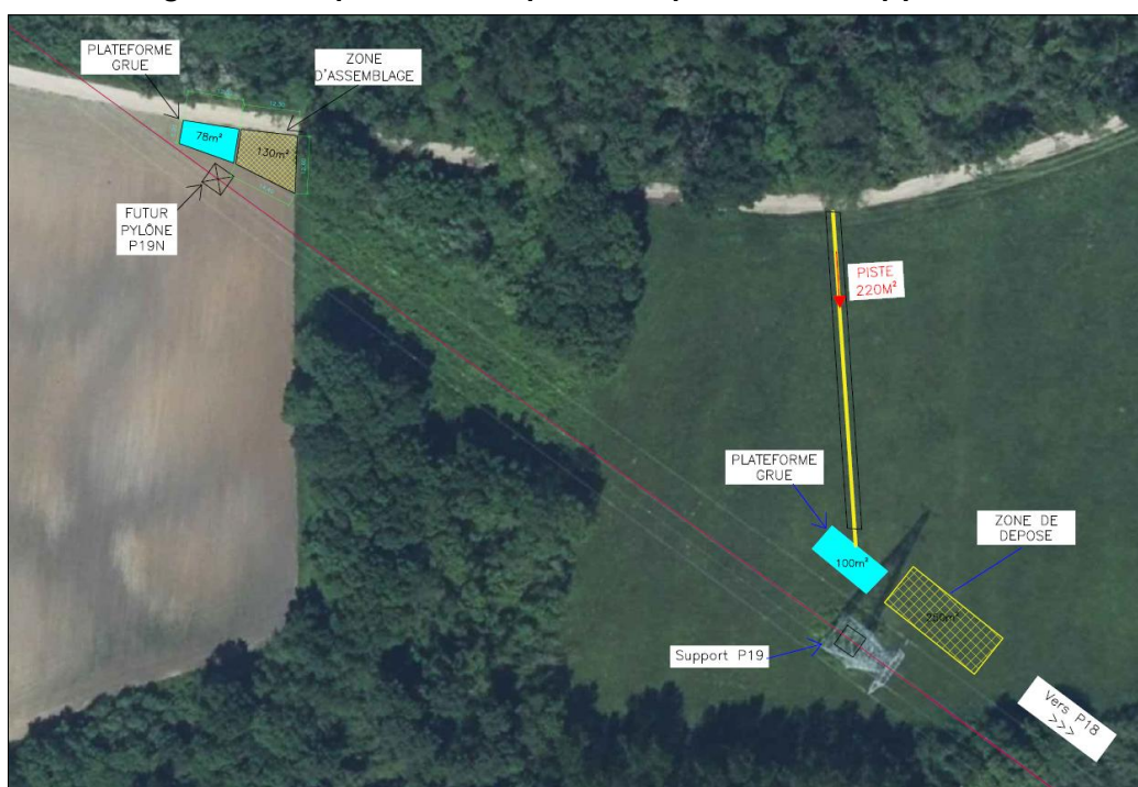
Figure 15 : Emprise travaux pour le déplacement du pylône 19
