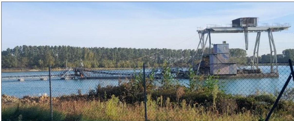
Figure 19 : Drague et bandes transporteuses flottantes (ENCEN)
