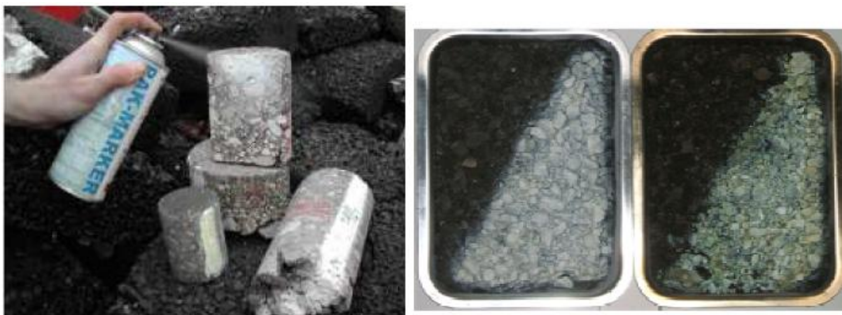
Figure 30 : Procédure de détection des goudrons au PAK-MARKER (test négatif – test positif)
