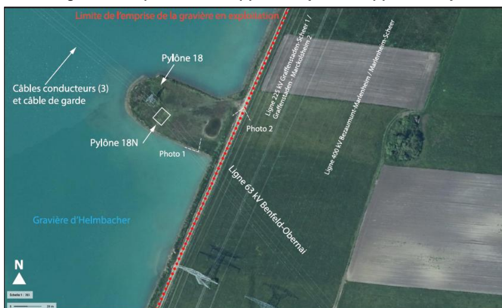
Figure 12 : Déplacement du pylône 18 (nouveau pylône 18 N)
