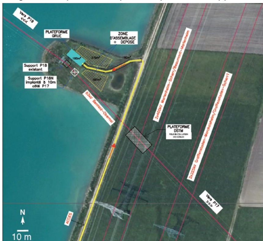
Figure 14 : Emprise travaux pour le déplacement du pylône 18
