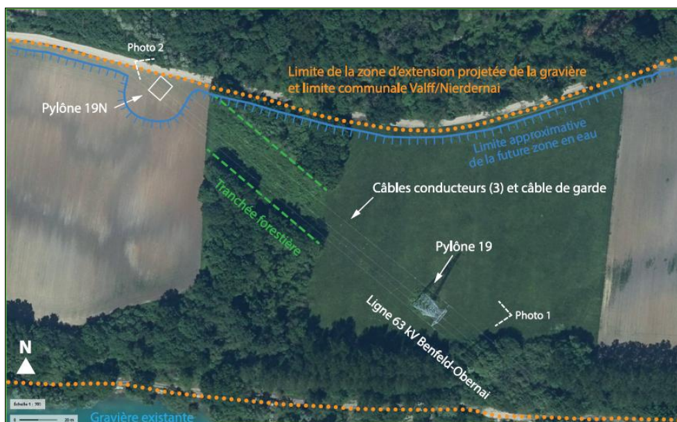
Figure 13 : Déplacement du pylône 19 (nouveau pylône 19N)
