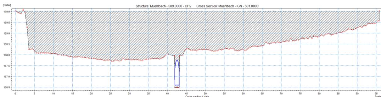
Figure 94 : Ouvrage hydraulique de type « conduite » modélisant la section hydraulique d'un ouvrage
