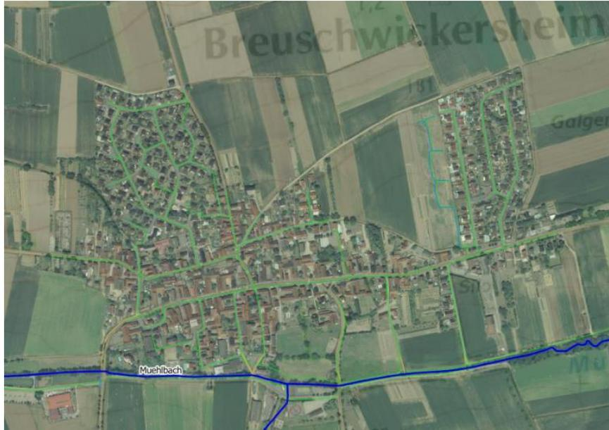
Figure 33 : Plan des réseaux d'assainissement (en vert l'unitaire, en bleu le pluvial séparatif) sur la commune de Breuschwickersheim
