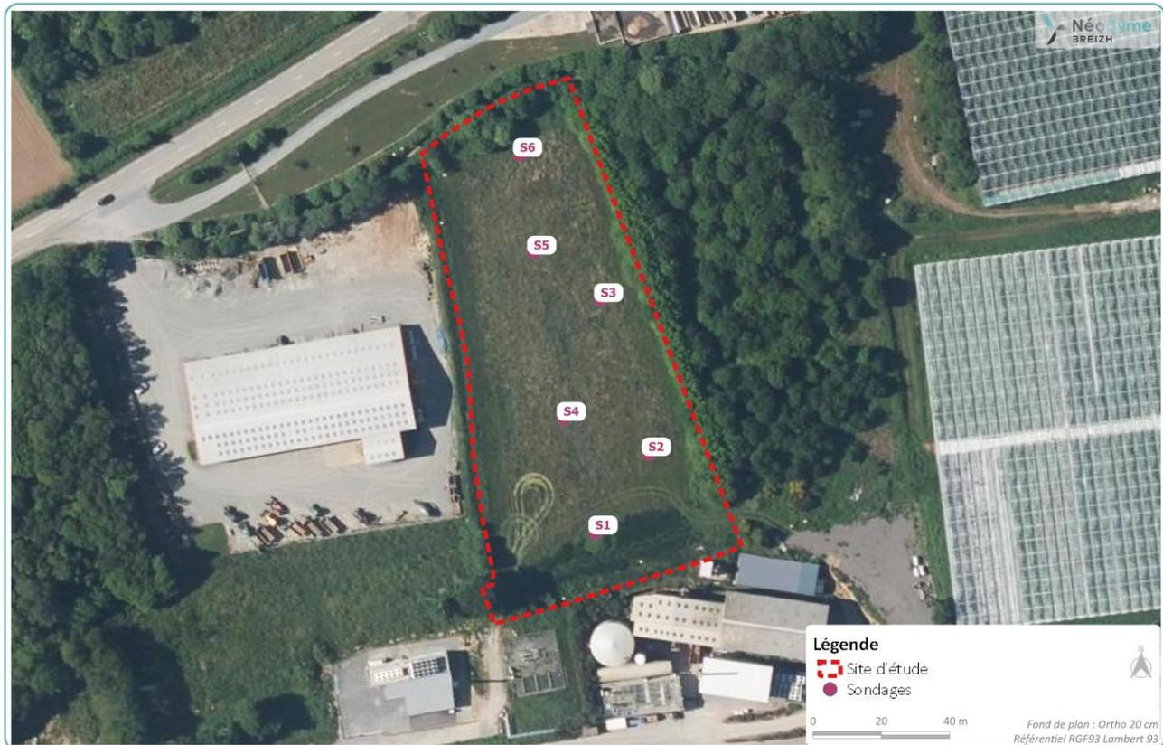
Figure 37 : Implantation des sondages
