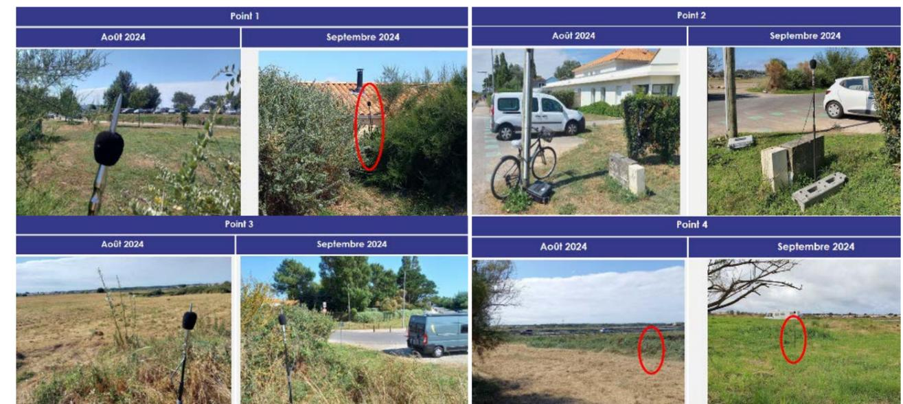
Les mesures ont été effectuées suivant les normes NF S 31-010 et NF-S 31-085. Les sonomètres utilisés ont été étalonnés en laboratoire depuis moins de 2 ans, calibrés avant la campagne de mesures et sont conformes à la norme NF EN 61672 relative aux sonomètres intégrateurs. Les réglages des sonomètres étaient les suivants : Niveau sonore moyen Leq ; Durée d'intégration d'1 seconde ; Mesures par bandes d'octave de 63 Hz à 8 kHz.
