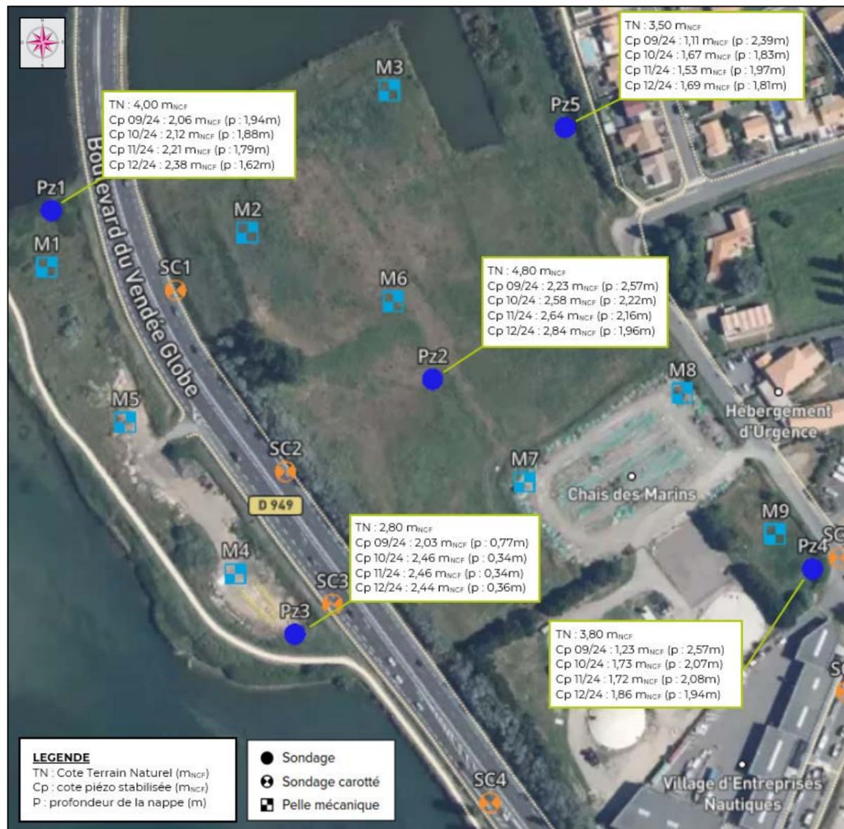
Figure 27 : Localisation des piézomètres et niveaux d'eau mesurés (période intermédiaire sept. à déc. 2024)
