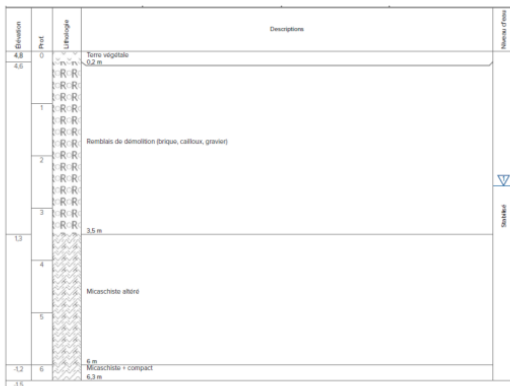
Coupe géotechnique sur remblai – PZ2 – Source : G2 AVP Ginger CEBTP
