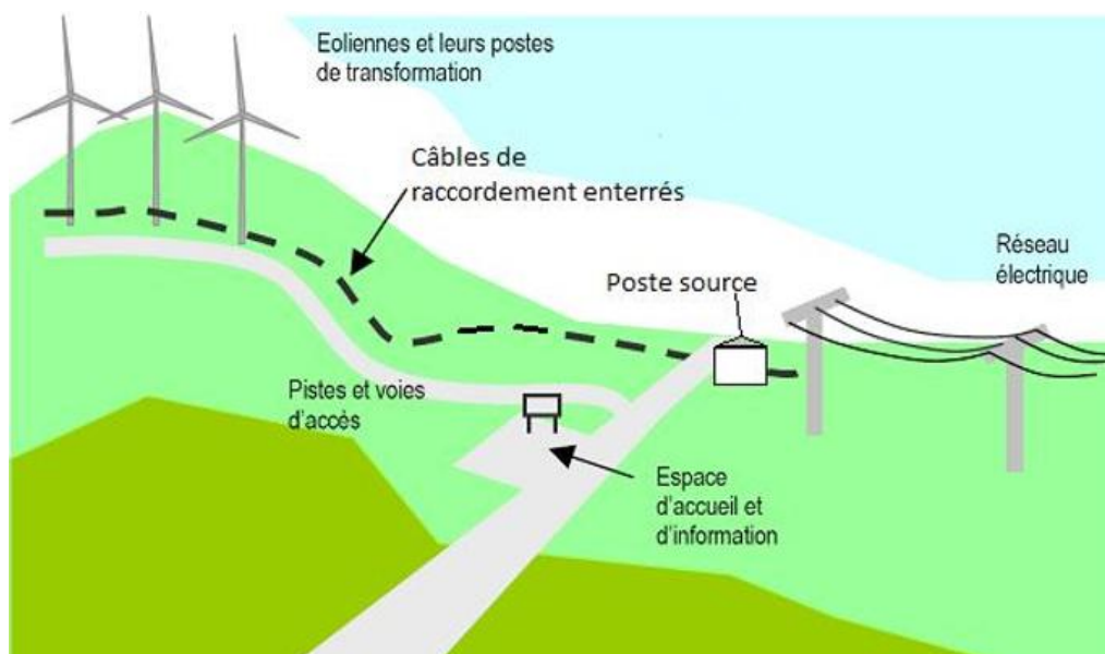
Figure 20 : Schéma descriptif d'un parc éolien
