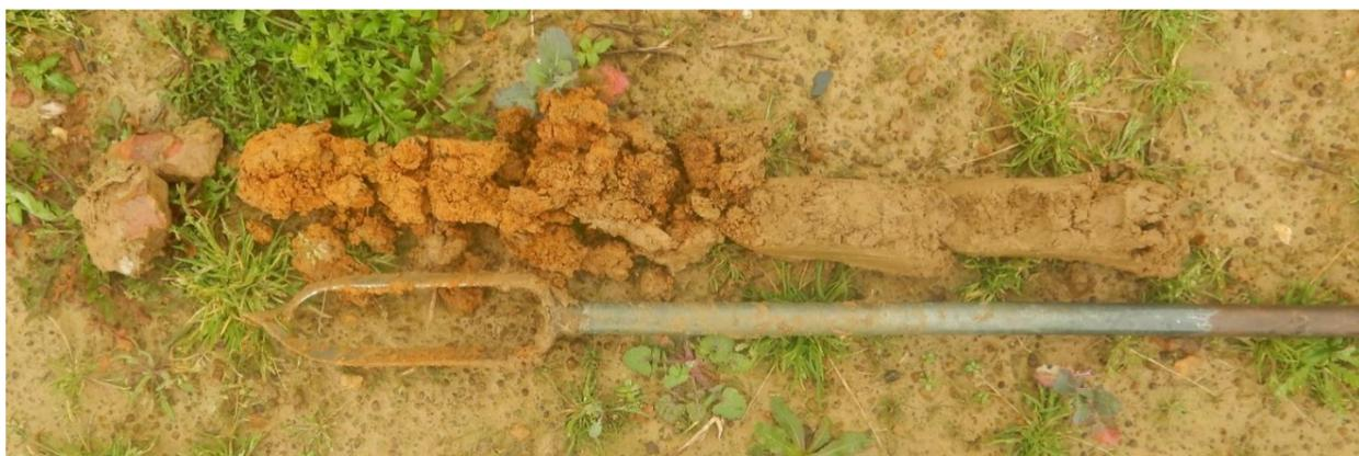
Photo 3 : Exemple de sondage réalisé sur une profondeur de 70cm
