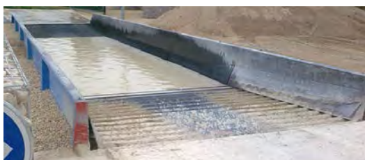
Exemple de rotoluve (source : servi-loire.com)
