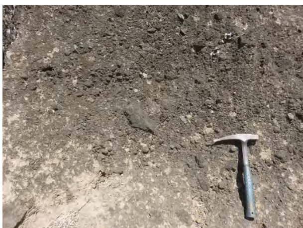
Tuf pouzzolanique cohérent riche en ponces, à élément de lave Source : Rapport de réalisation des sondages sur le site – Mascareignes Géologie
