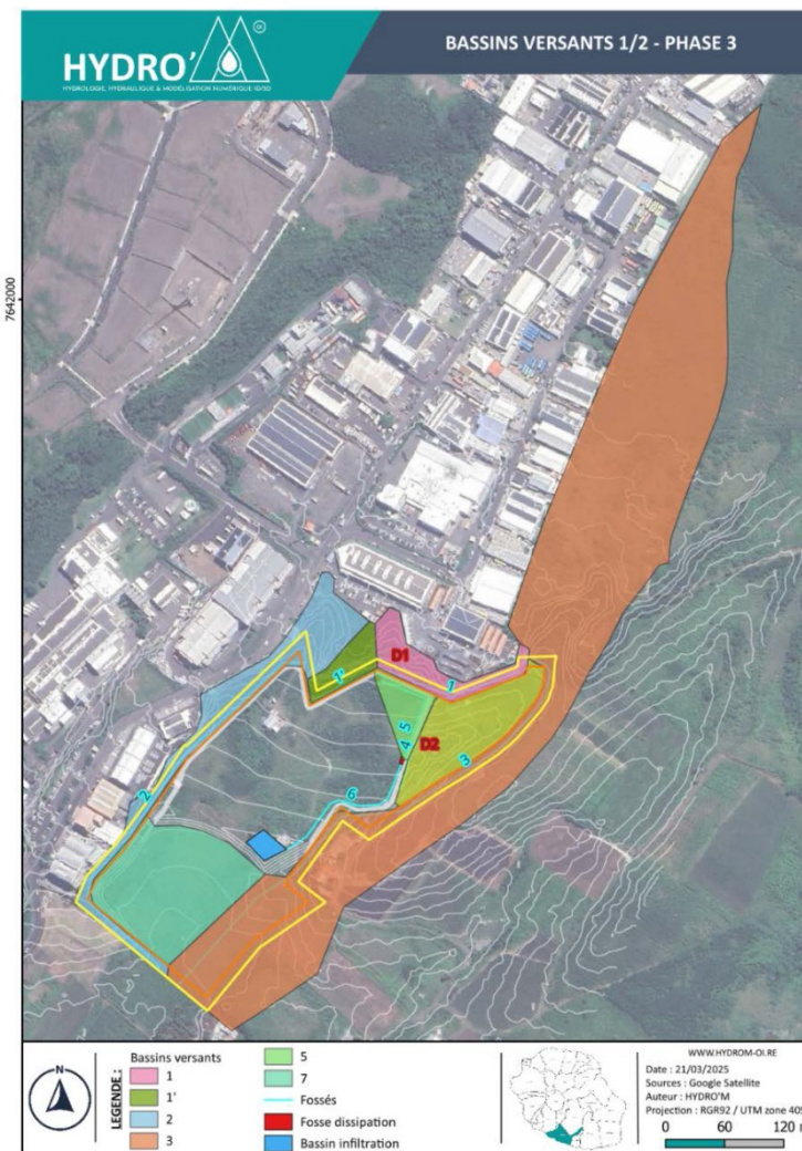
Illustration 9 : Implantation des ouvrages hydrauliques et bassins versants – Phase 3 Source : Etude hydraulique - HYDROM
