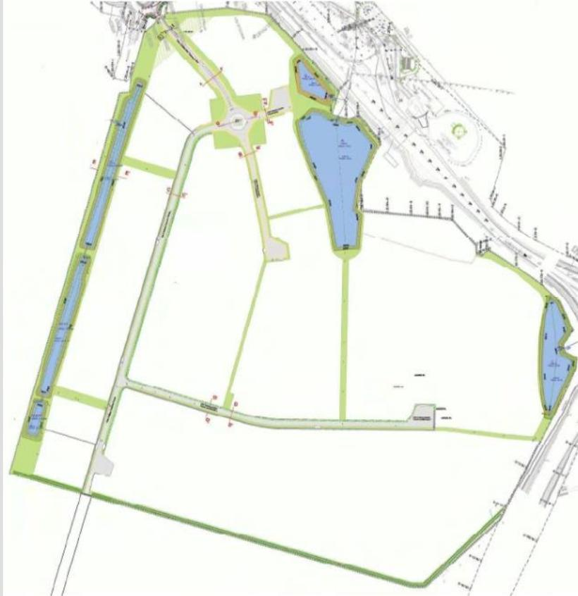
Figure 2-1 : Bassins de rétention des eaux pluviales
