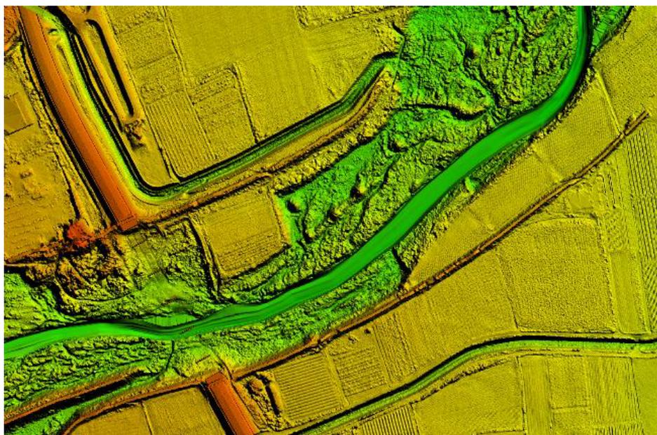
Figure 10: Exemple de MNT après intégration de données des profils en travers sur le Golo aval (Source : BRLi)
