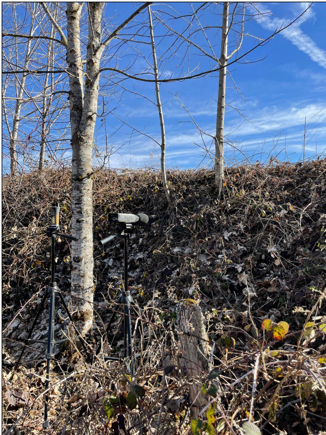
Figure 10 : Photographie du sonomètre lors de la mesure du niveau sonore en limite de site (point LIM sur la Figure 1)
