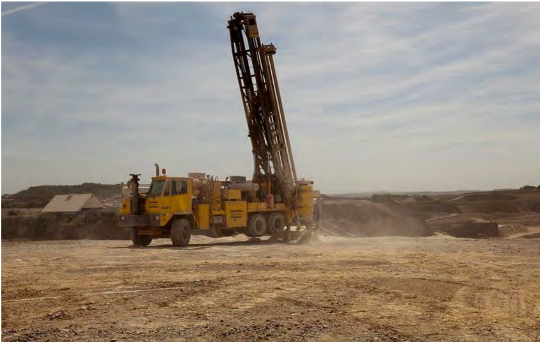
Forage : préparation des tirs de mines
